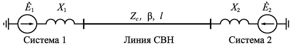
Рис. 10. Схема замещения электропередачи СВН
