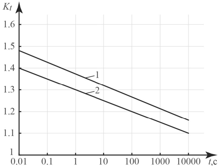
Рис. 4. Характеристики «напряжение-время»
