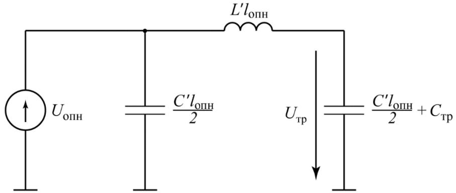
Рис. 2. Схема замещения для расчёта напряжения на трансформаторе ( $U_{\text{опн}}$  – напряжение на ОПН;  $L'$  и  $C'$  – погонные индуктивность и ёмкость ошиновки;  $l_{\text{опн}}$  – длина ошиновки между ОПН и автотрансформатором;  $C_{\text{тр}}$  – входная ёмкость трансформатора)
